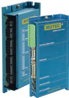
低压智能伺服包括标准直流系列和ARES系列。标准直流系列驱动器电流3A~50A，可以驱动各种类型的无刷和有刷低压伺服电机，电压范围12.5V~180VDC，电机功率可达2KW以上，支持几乎所有的主流电机编码器。驱动器和电机均可提供针对高低温、三防要求的产品。ARES系列直流具有超高性价比，目前功率范围 50W~750W，组合固定，便于客户选择。2个系列驱动器均支持内置 PLC、CAN总线功能，2017年直流系列会推出Ethercat驱动器。
